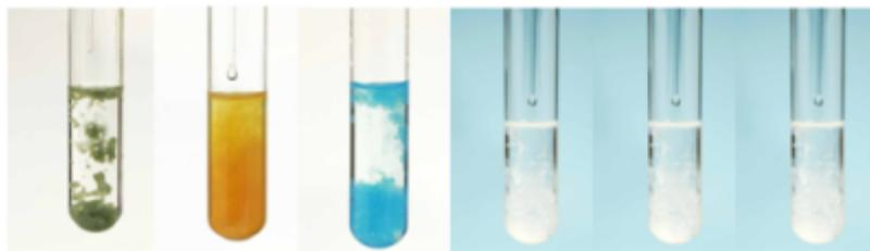
➤ test de reconnaissances des ions hydrogène  $H^+$  et des ions hydroxyde  $OH^-$
